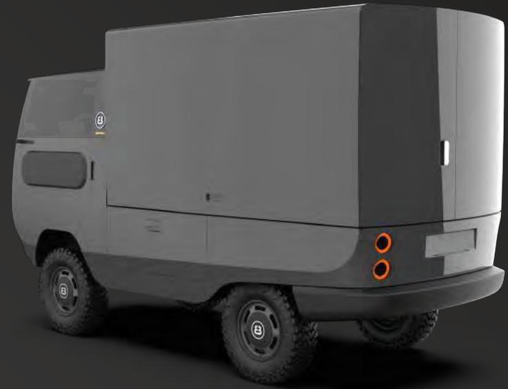
Standard-/Offroad-Fahrgestell mit Mittelmodul und Koffermodul I, oder Koffermodul II begehbar. Bis zu 5,3m<sup>3</sup> Ladevolumen. 10 Kw/h Batteriekapazität mit ca. 200km Reichweite (optional bis zu 30 Kw/h und 600km Reichweite), Allradantrieb und Solardach in Fahrerkabine und Kofferaufbau, Soundsystem, Rekuperation und Vieles mehr.
