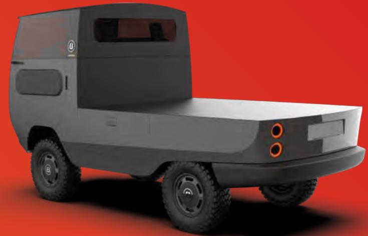
Standard-/Offroad-Fahrgestell mit/ohne Mittelmodul 1, 10 Kw/h Batteriekapazität mit ca. 200km Reichweite (optional bis zu 30 Kw/h und 600km Reichweite), Allradantrieb und Solardach in der Fahrerkabine, Soundsystem, Rekuperation und Vieles mehr.
