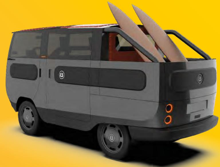
Standard-/Offroad-Fahrgestell mit Fond-Modul 1 und Pick-Up-Klappen 2, oder Kofferraum-Modul 1. 10 Kw/h Batteriekapazität mit ca. 200km Reichweite (optional bis zu 30 Kw/h und 600km Reichweite), Allradantrieb und Solardach in den Modulen Kabine Fond und Kofferraum – bei Cabrio herausnehmbar, Soundsystem, Rekuperation und Vieles mehr.
