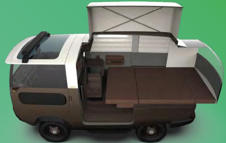
Standard-/Offroad-Fahrgestell mit Camping-Modul I + II. Liegefläche ca. L210cm – B130cm. Kühlschrank, TV, Kochfeld, Frischwasser-Tank und Spüle. 10 Kw/h Batteriekapazität mit ca. 200km Reichweite (optional bis zu 30 Kw/h und 600km Reichweite), Allradantrieb und Solardach in 3 Modulen, Soundsystem, Rekuperation und Vieles mehr.
