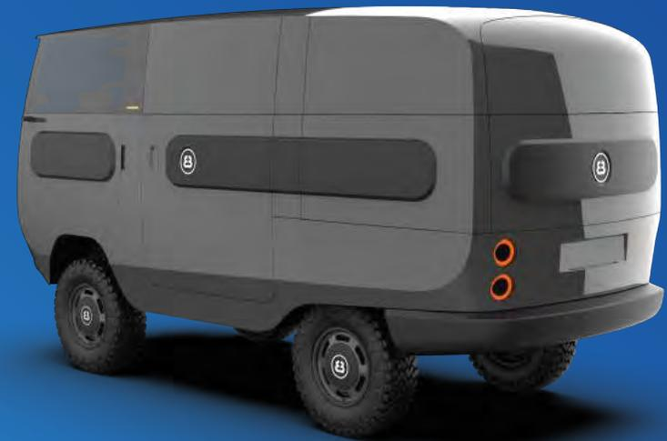
Standard-/Offroad-Fahrgestell mit Fond-Kabine und Pick-Up-Klappen 2, oder als Bus/Kombi mit Fenstern oder geschlossen. Für 2-4 Personen. 10 Kw/h Batteriekapazität mit ca. 200km Reichweite (optional bis zu 30 kW/h und 600km Reichweite), Allradantrieb und Solardach vorne, mittig und/oder hinten. Soundsystem, Rekuperation und Vieles mehr.
